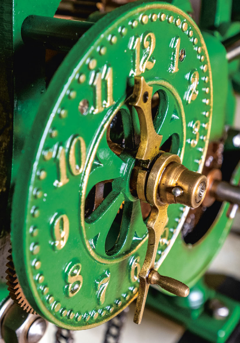
Das gusseiserne Uhrwerk steuert den Glockenschlag zu jeder halben und vollen Stunde.
