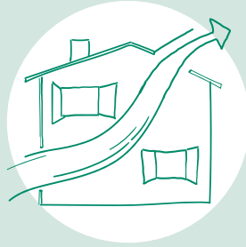
Stosslüften vertikal (von Keller bis Dach)
